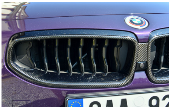
Karbonové ledviny jsou vybaveny systémem elektromotoricky ovládaných lamel.
